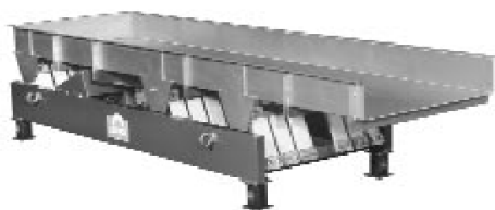
6. att. Elektromagnētiskā konveijera piemērs.
