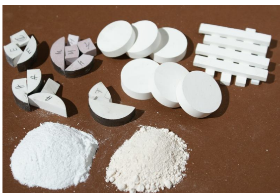
2.6. att. Sagatavoti izejas pulveru maisījumi un apdedzinātie/saķepinātie keramikas paraugi
