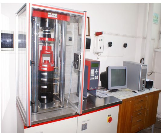
2.9. att. Spiedes izturības pārbaudes iekārta TONI Technik Controller TT 0995
