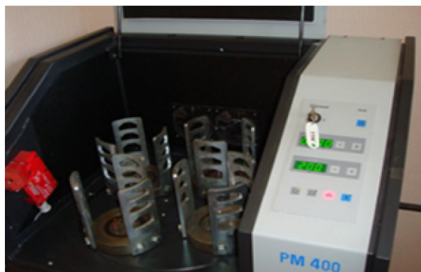
2.2. att. Planetārā ložu dzirnavā RETSCH PM 400
