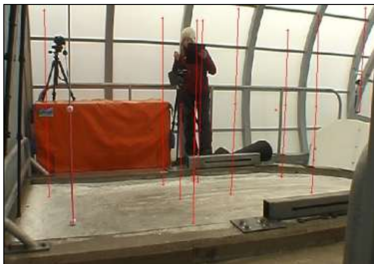
2.8. att. Testa objekta pozīciju attēlojums kalibrēšanas videoieraksta kadrā
