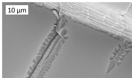
4. attēls. SEM-BSE mikrogrāfija. Monolīta daļēji sakristalizēta stikla parauga lūzums
