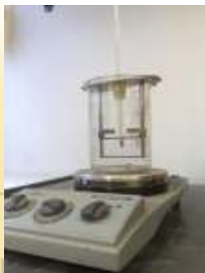
3. att. Iekārta „gredzens un lodīte” bitumenu mīksttapšanas temperatūras noteikšanai
