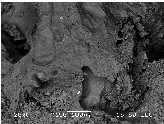
6.att. 1120 °C temperatūrā iegūta G6 kompozītmateriāla mikrostrukturā.
