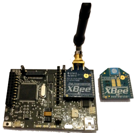
P.1.2. att. Waspnote procesora un komunikāciju plate un XBee moduļi
