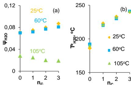
Fig. 12 Water weight fraction  $\psi_{H_2O}$  in gels (a) and  $T_{H_2O}^e$  values (b)
