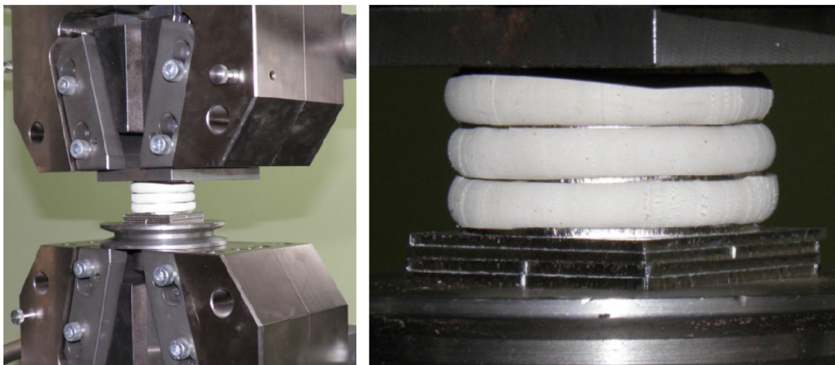
4.3. att. Plānslāņa gumijas - metāla kompensatora saspiešana testēšanas mašīnā ZWICK/Roell Z-150
