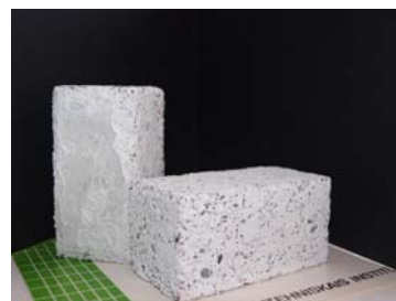
8.att. Betona paraugu korozija pēc eksponēšanas 0.25M sērskābē.
