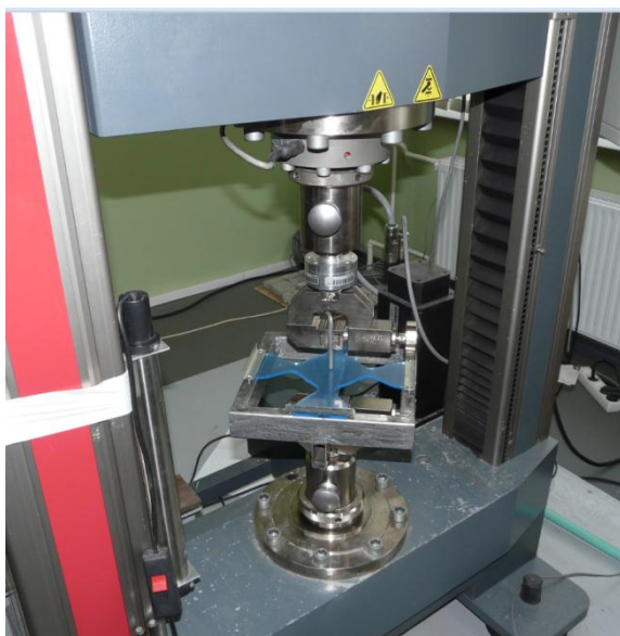
2.14. att. Fizikālie eksperimenti uz Zwick Roell Z 150 testēšanas mašīnas un plāksnītes piestiprinājuma konstrukcija
