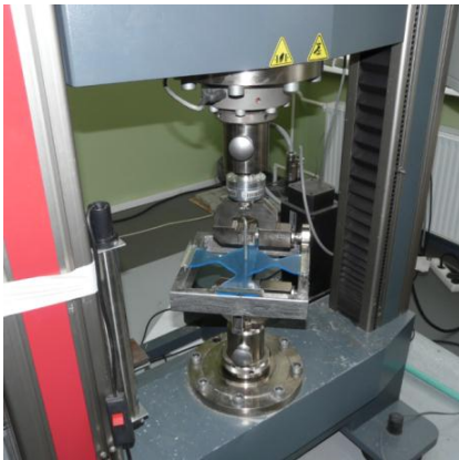
4. att. Liektas plāksnītes fizikālie eksperimenti uz Zwick Roell Z 150 testēšanas mašīnas un aprēķinātās vidējo vērtību (Vid) līknes katram paraugam: [Liang, 2001] (A), optimālā forma, kas iegūta ar izstrādāto metodiku (E), grieķu krusts (F) un kvadrātiska plāksnīte (G)
