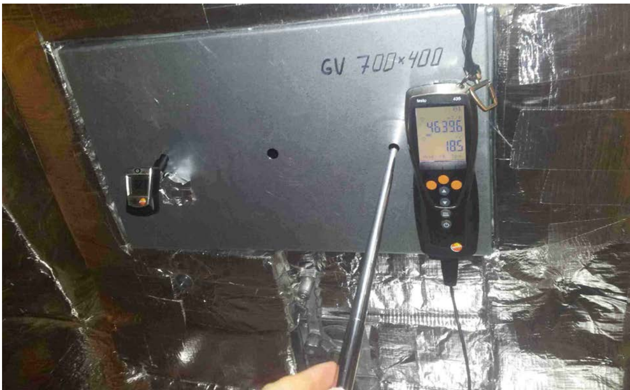
4.7. att. Dzesētāja izmešanas gaisa parametru mērīšana
