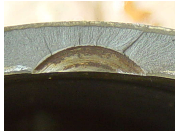
17. att. Koncentrators-iezāģējums (iegūts pēc sagraušanas)
