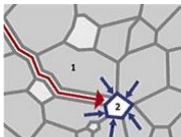
1.9. att. Transformācijas mehānisms ZTA keramikā (1 – \text{Al}_2\text{O}_3 grauds; 2 – \text{ZrO}_2 grauds) [157]
