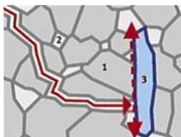
1.10. att. Plaisu novirzīšanas mehānisms ZTA keramikā, kas modificēta ar \text{SrO} piedevu (1 – \text{Al}_2\text{O}_3 grauds; 2 – \text{ZrO}_2 grauds; 3 – plāksnītes veida kristāls) [157]
