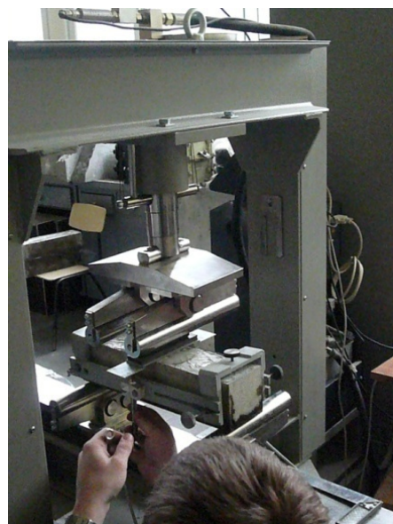
5. att. Prizmu testēšana uz četru punktu lieci.
