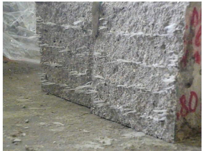
9. att. Betona B50 prizmas (ar 4 armējošiem sietiem) virsma pēc pilnīgas parauga pārlaušanas.
