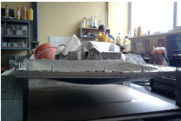
4. att. Izliektas čaulas formas veidošana ar pašsvaru.
