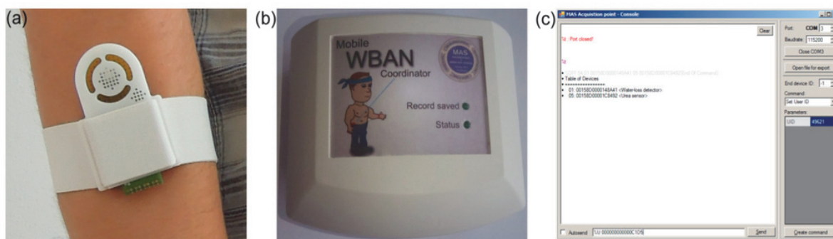
5.1. attēls. MAS WBAN eksperimentālais komplekts: (a) bezvadu sviedru sensors; (b) vadības mezgls; (c) lietojumu slānis.
