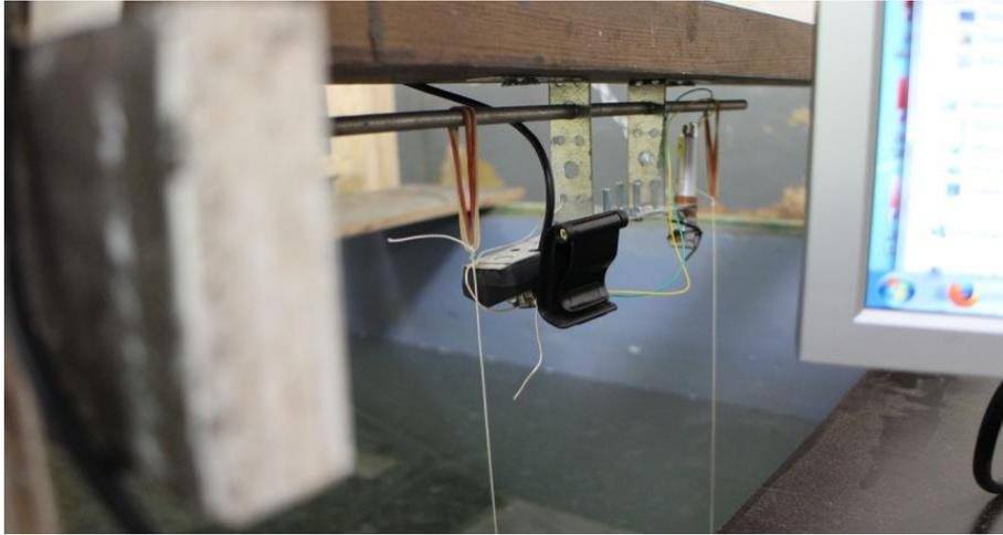
Fig. 4.5. Laser sensor.
