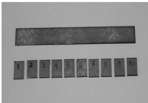
1.att. PINOK sagatave pirms (augšā) un pēc (apakšā) sadalīšanas paralēlos paraugos ar dimanta abrazīva disku.
