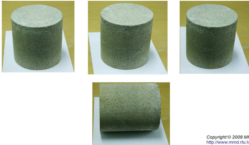
5. attēls. Testēšanas mašīnā Instron 8802 uzformētie betona cilindru paraugi
