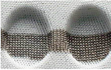
9. att. Adīta drāna no vadošiem pavedieniem un viedā „datorpele” iestrādāta piedurknes atlokā.
