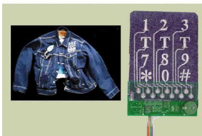
8.att. Uz džinsu jakas uzšūta elektronikas vadības sistēma
