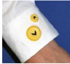
9. att. Adīta drāna no vadošiem pavedieniem un viedā „datorpele” iestrādāta piedurknes atlokā.
