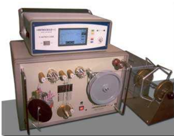
5.att. Berzes koeficienta mērīšanas iekārta F-Meter R-2088
