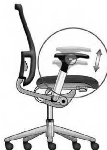
6. att. Darba krēsla rokturu regulēšanas iespējas [7]
