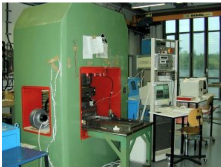
2.14 att. 1000 tonnu prese ar kompaktēšanas bloku
