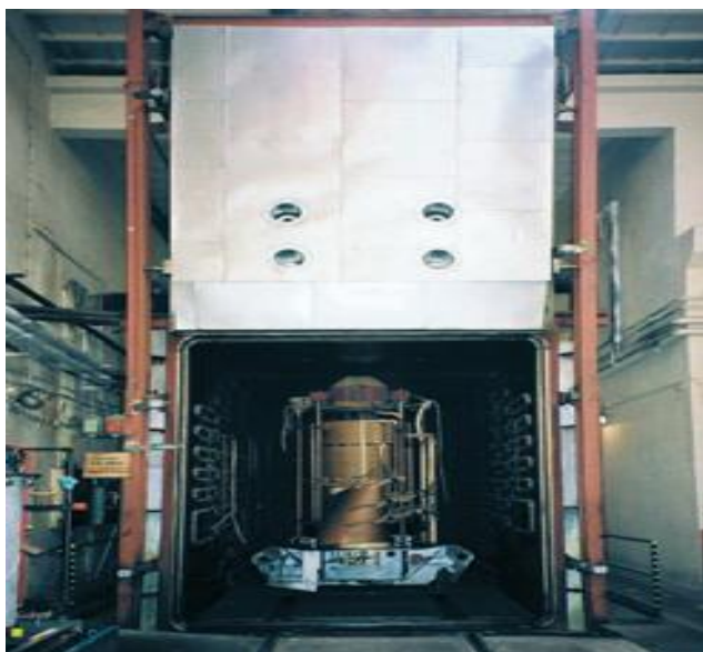
3. att. Transformatora tinumu mazgāšana un žāvēšana.
