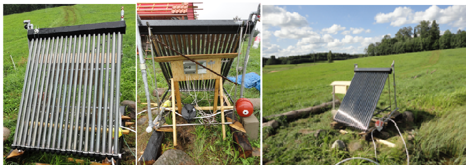
3.1. att. Vakuuma cauruļu saules kolektora eksperimentālās izpētes sistēma
