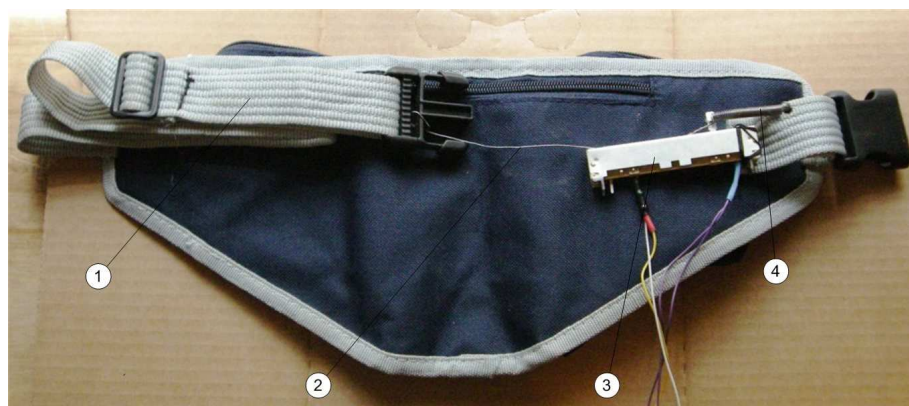
4.8.att. Elpošanas sensora piesaistes sistēma: 1) josta, 2) savienojošā stīga, 3) Sprieguma dalītājs ar bīdes potenciometru 4) bīdņa atgriezējatspere.
