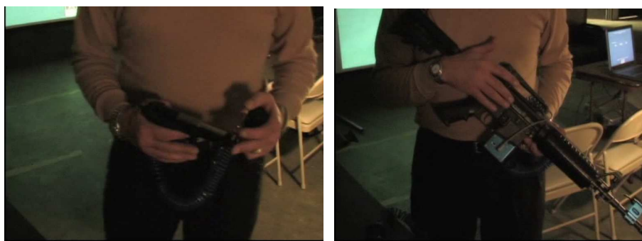
1.11.att. Pistoles un trieciensāutene ar atsitienu simulācijas iekārtām.
