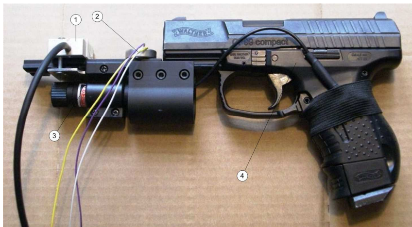
4.7. att. Pistole ar sensoriem: 1) divvirzienu nolieču sensors, 2) mikrofons, 3) lāzera izstarotājs, 4) pistoles Walther P99C pneimatiskais modelis.
