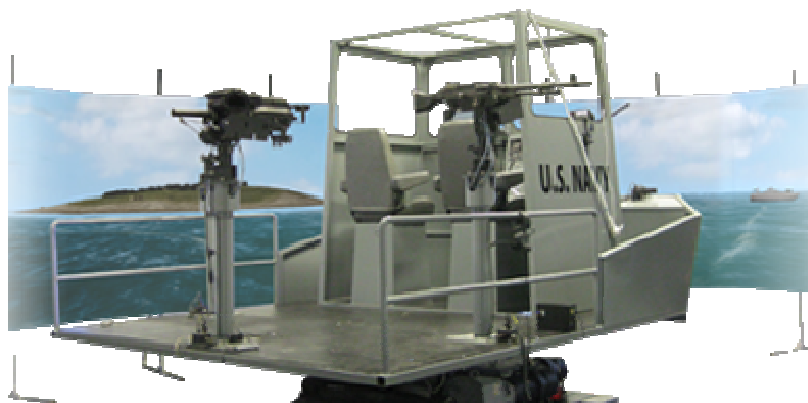
1.10.att. Militārā kutera tiltiņš uz hidrauliskās sistēmas
