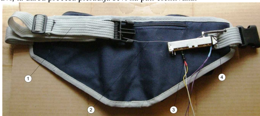
Att. 12. Elpošanas sensora piesaistes sistēma: 1) josta, 2)savienojošā stīga, 3)Sprieguma dalītājs ar bīdes potenciometru 4)bīdņa atgriezējatspere
