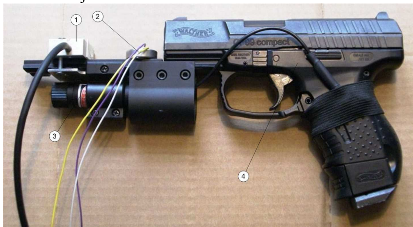
Att. 11. Pistole ar sensoriem: 1) divvirzienu nolieču sensors, 2)mikrofons, 3) lāzera izstarotājs, 4) pistoles Walther P99C pneimatiskais modelis
