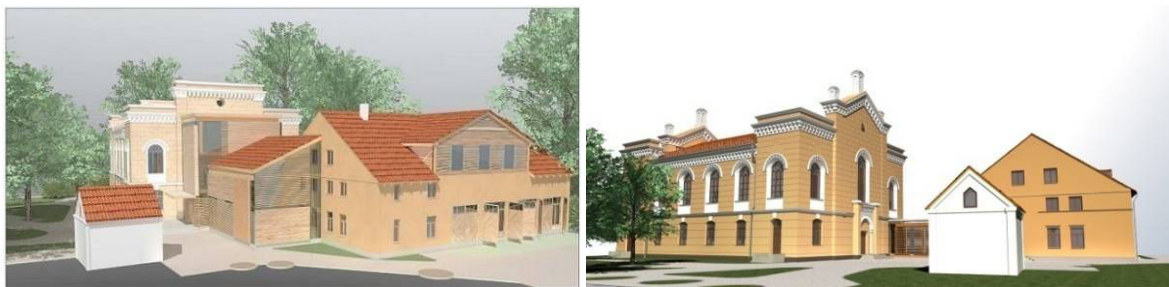
3.3.15. un 3.3.16. att. Kuldīgas sinagogas ēku kompleksa pārbūves projekts par novada bibliotēku. Pa kreisi – projekta sākotnējais variants (ar apjomīgām piebūvēm), pa labi – realizējamā projekta variants – apjomi netiek mainīti, tikai savienoti ar galeriju [440].
