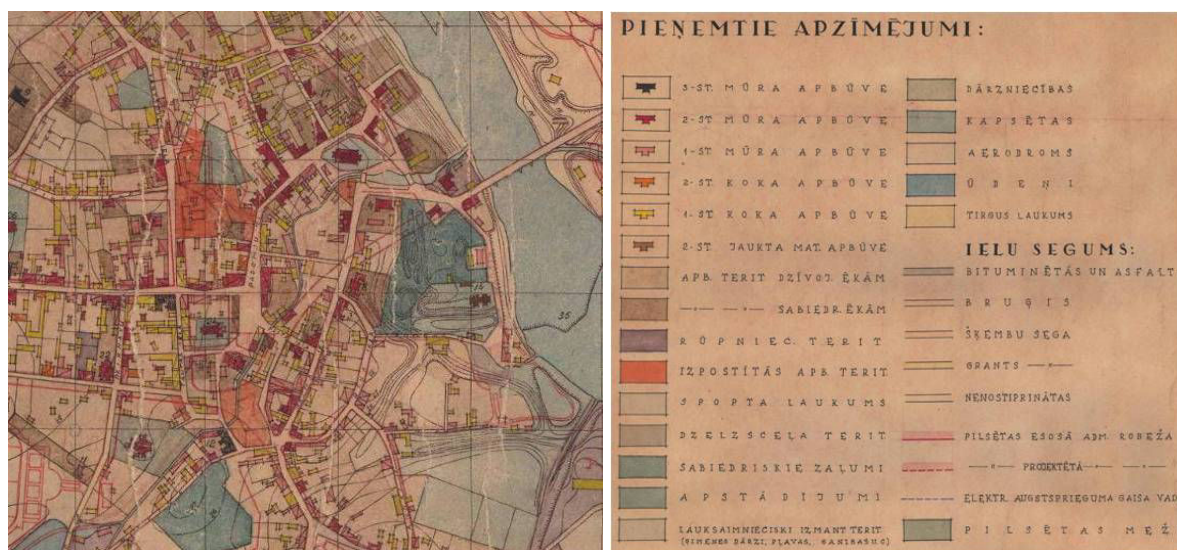
1.3.4. att. 1948. g. ģenerālplāna fragments. Pilsētas centrālā daļa. Ar sārta krāsu iezīmētas izpostītās apbūves teritorijas, ar sarkanu līniju – projektētās ielas. [249]
