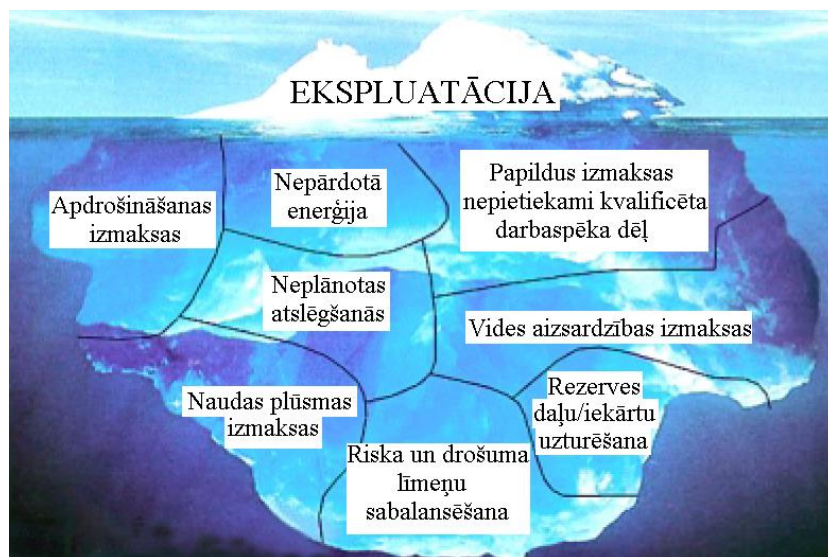
1.1. att. Transformatoru ekspluatācijas netiešās izmaksas
