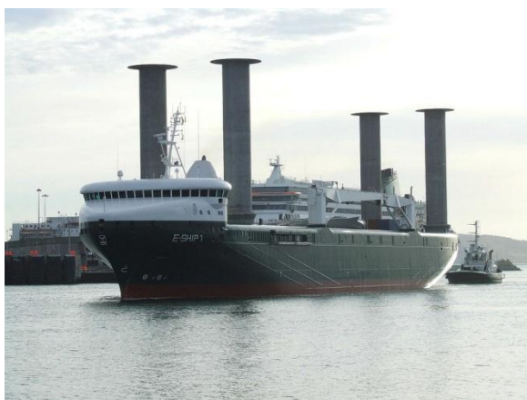
Att. 3. Kuģis ar rotorburām
