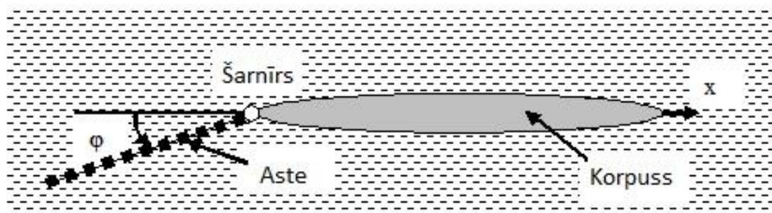
Att. 4.1.1. Vienkāršots robota modelis
