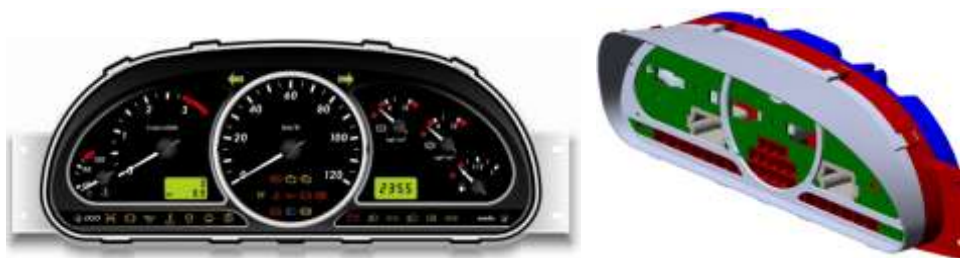
Attēls 7.1 Uzņēmuma Merpro kontroles mērinstrumenta paneļa (KMP) dizains, kas projektēts AMO PLANT un 3D ģeometriskais modelis
