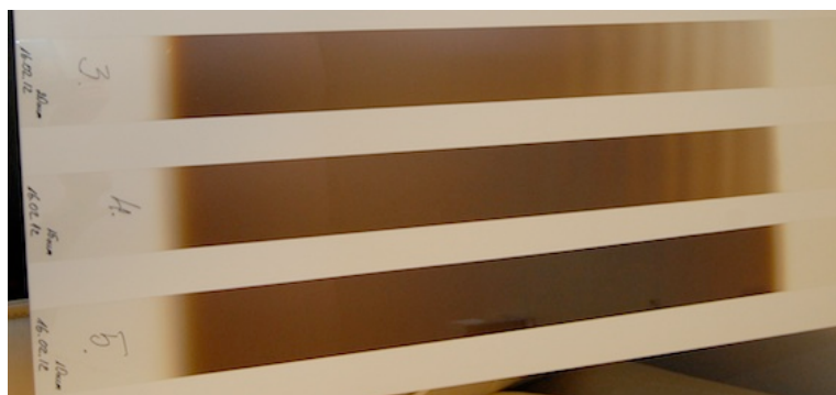
3.2.att. Skābekļa plūsmas lokālu izmaiņu ietekme uz pārklājuma viendabīgumu
