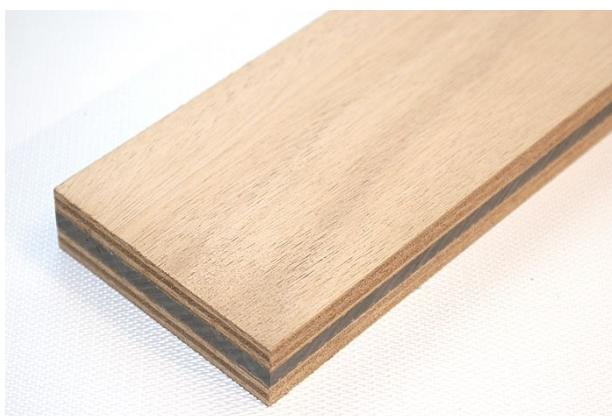
1.8. att. Saplāksnis ar viskozu vidējo slāni [86].
