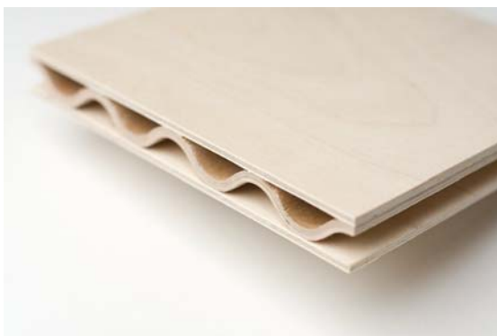
1.6. att. Ribots saplāksnis ar viļņota saplākšņa vidusslāni ( corrugated core ) [73, 58].
