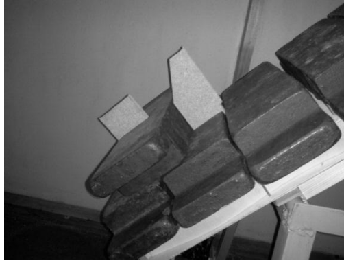
6.38.att. Slodzes pielikšana un nofiksēšanas mehānismi pret noslīdēšanu.
