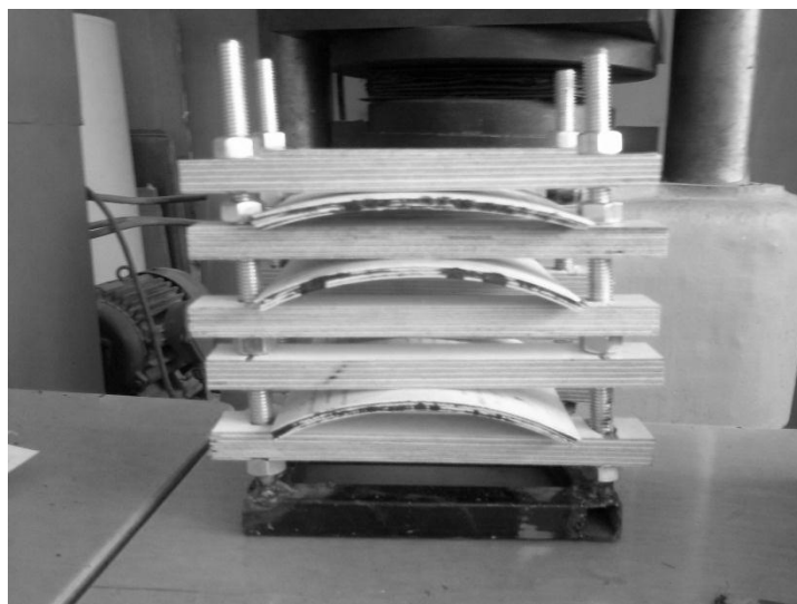
2.14. att. Termiskās apstrādes rāmis izliektām, nesimetriskas struktūras saplākšņu loksņēm.
