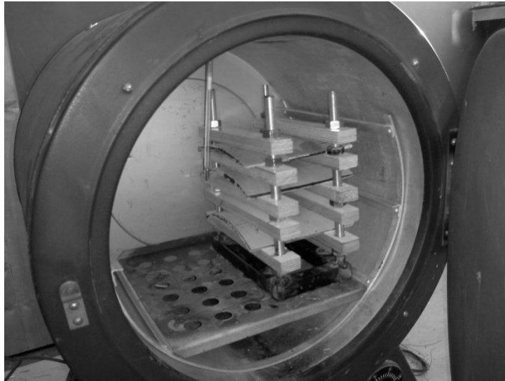
2.15. att. Paraugu termiskās apstrādes iekārta.
