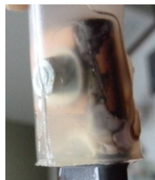
3.52. att. Elektrods ar korodējušu kontaktvietu
