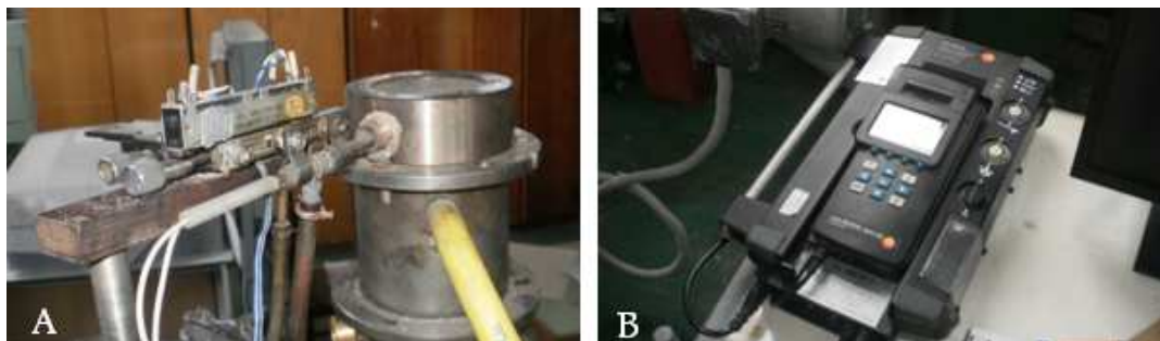
2.8. att. Izmantojamie mērinstrumenti a – Pt/Pt-Rh termopāri; b – analizators TESTO 350-M/XL, 454
