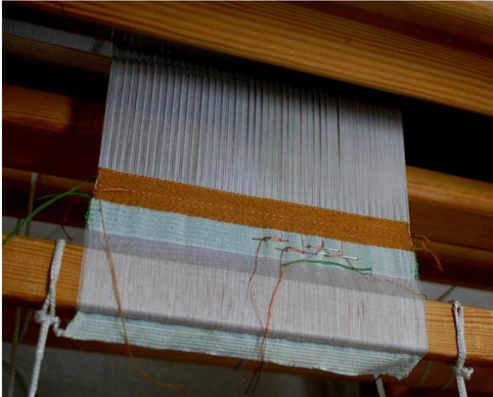
3.31. att. Elektrotekstilija stellēs aušanas procesā
