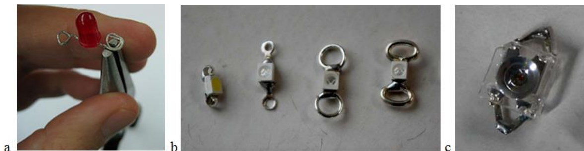
1.34. att. Pievienošanai sagatavotās diodes – a: LED T1 korpusā [113]; b: 1206 izmēra SMD LEDs ar pielodētu metāla furnitūru; c: diodes ar salodētiem kontaktizvadiem
