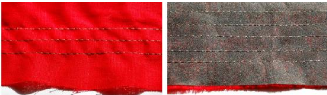
3.2. att. Šuve – a: uz nedublētas drānas; b: un dublētas drānas
