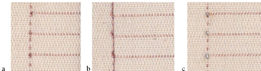
3.10. att. Elektroda kontaktu savienojuma veidi – a: mezgla savienojums austajā sensorā; b: mezgla savienojums austajā / šūtajā sensorā; c: lodēts savienojums austajā sensorā.
