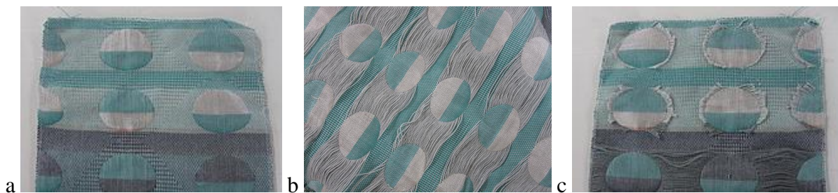
1.19. att. Elektrovadošais audumu ar individuāliem elektrovadošajiem laukumiem – a auduma labā puse; b: auduma kreisā puse ar nepārgrieztām pārsedzēm; c: auduma kreisā puse ar pārgrieztām pārsedzēm [55]
