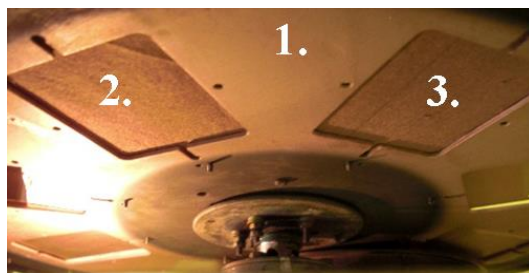
2.3. att. Rotējošs disks (1), virs kura nostiprināti tekstilmateriāla paraugi (2, 3): (7gb)
