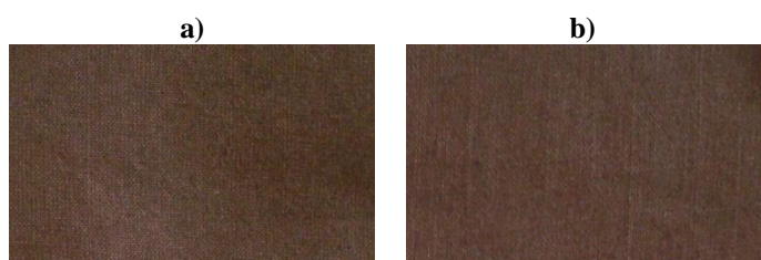
3.1. att. Tekstilmateriāls (Nr. 9) pārklāts ar varu termiskās iztvaicēšanas tehnoloģijas procesā a) pārklājuma biezums 60 nm (uznešanas laiks 1 s), b) pārklājuma biezums 180 nm (uznešanas laiks 3 s)
