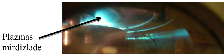
2.5. att. Paraugu apstrāde ar plazmas mirdzislādi
