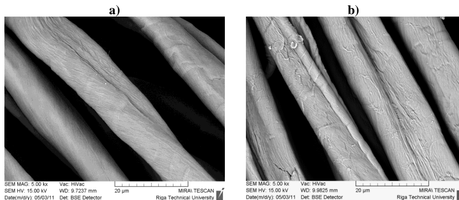
3.13. att. Magnetrona izputināšanas tehnoloģijas procesā iegūta 30 un 180 nm bieza vara pārklājuma struktūra uz kokvilnas tekstilijas (Nr. 9) virsmas a) pārklājuma biezums 30 nm (vara uznešanas laiks 20 s, viena parauga eksponēšanas laiks 1,5 s), b) pārklājuma biezums 180 nm (vara uznešanas laiks 120 s, viena parauga eksponēšanas laiks 9 s)
