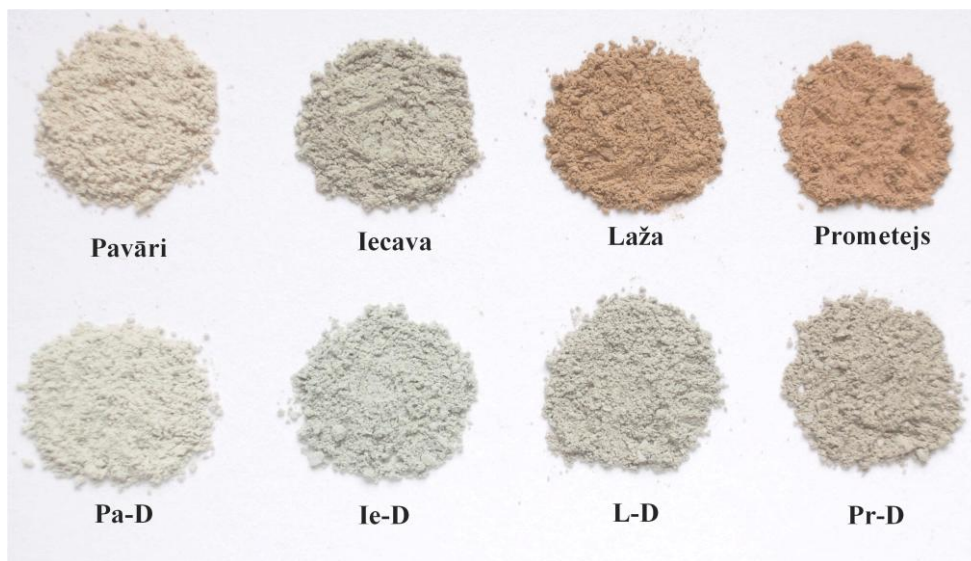
3.3. att. Māli pirms un pēc dzelzs savienojumu atdalīšanas
