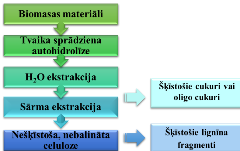
1.5. att. Biomasas frakcionēšanas shēma pēc tvaika sprādziena autohidrolīzes (izstrādāta Latvijas Valsts Koksnes ķīmijas institūtā, Biomasas eko-efektīvas konversijas laboratorijā)[1]
