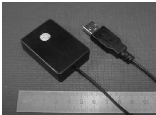
4.2. att. Eksperimentālajos testos izmantotā pierakstos minētā ierīce (dimensijas 49 mm x 35 mm x 8 mm)
