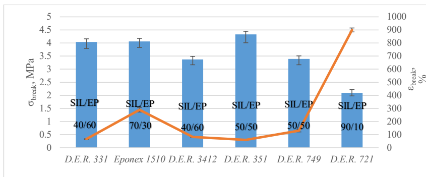
3.5.1.1. att. SIL/EP sistēmu stipres stiprība un deformācija pie sagraušanas pēc 28 dienu cietēšanas standartapstākļos – 23 °C un 50 % mitrumā (zilā histogramma – sagraušanas stiprība, oranžā līkne – sagraušanas deformācija).
