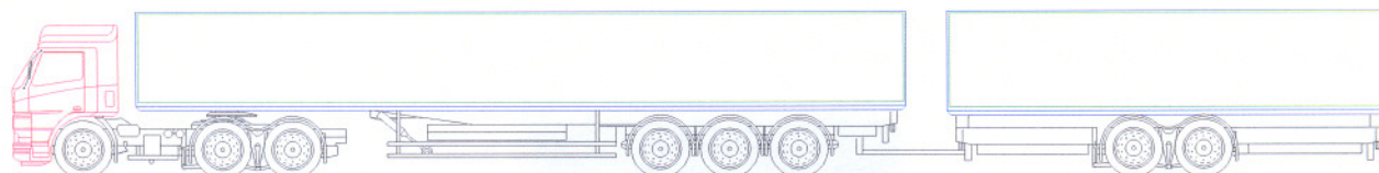
Trīs asu vilcējs + puspiekabe (kravas telpa 13,6 metri) + divu centrālasu piekabe (kravas telpa 7,82 metri)
