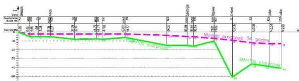
Piezīmes: 1) grafika vertikālā ass atēlo augstumu izmaiņas milimetros; 2) grafika horizontālā ass atēlo nivelēšanas gājieni ievēros ģeodēziskos augstuma punktus. Attālums starp punktiem norādīts kilometros; 3) nepārtrauktā grafika līnija norāda augstumu starpības starp 2001. – 2002. gadā mērītā nivelēšanas gājiena iegūtiem augstumiem un 1967. – 1968. gadā mērīto punktu augstumiem; 4) pārtrauktā grafika līnija norāda prognozētās augstuma starpības, kas iegūtas no vertikālo Zemes kustību modeļa 34 gadu periodā.
